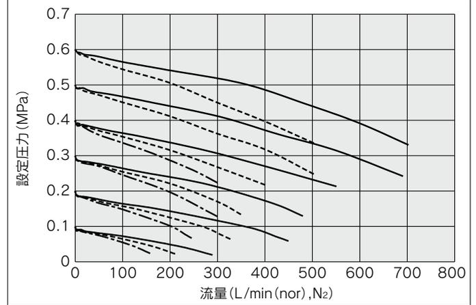
AK1410T 入口側圧力：—— 10MPa - - - - - 3MPa - · - · - 1.5MPa
