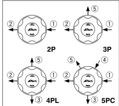
配管接続方式(入口側①、出口側②)
